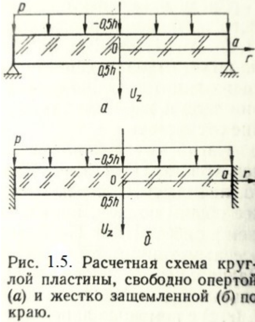
Рисунок 1.5. Расчётная схема круглой пластины, свободно опертой (а) или жёстко защемлённой (б) по краю.
