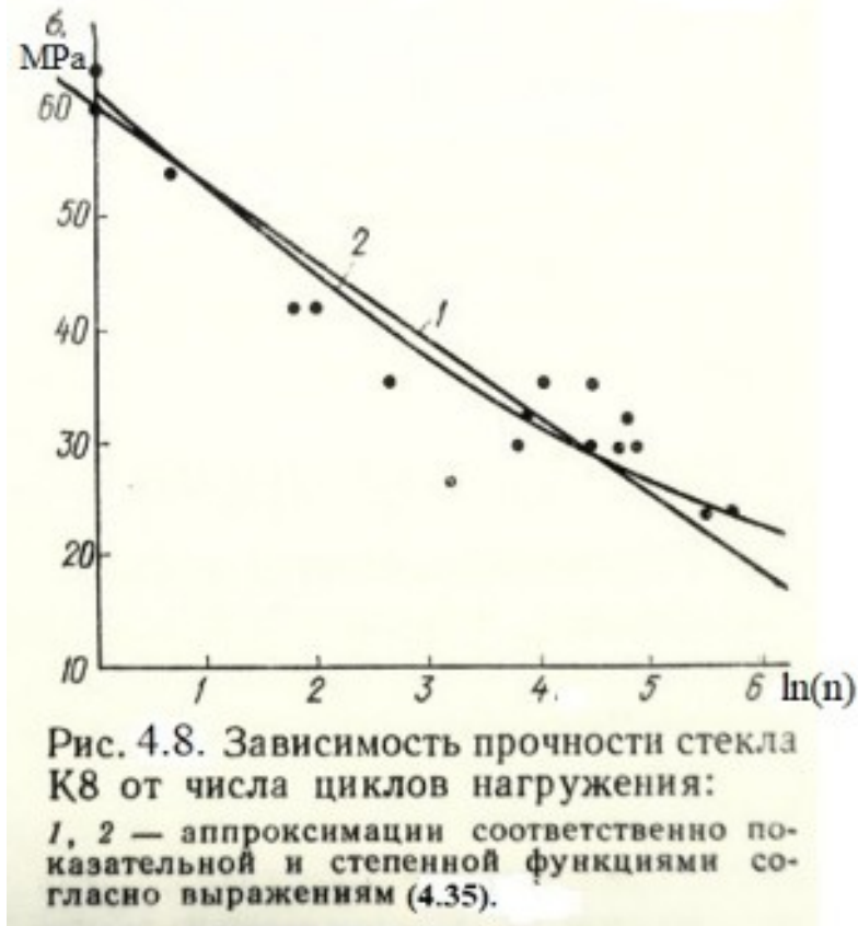
Рисунок 4.8. Зависимость прочности стекла от числа n циклов нагружения: 1, 2 — приближения соответственно показательной и степенной функциями по формулам (4.35).
