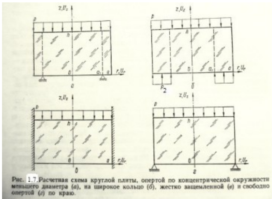
Рисунок 1.7. Расчётная схема круглой плиты или пластины, опёртой по концентрической окружности меньшего радиуса (а), с повышенным равномерным периферическим противодействием (б), жёстко закреплённой (в) или свободно опёртой (г) по краю.
