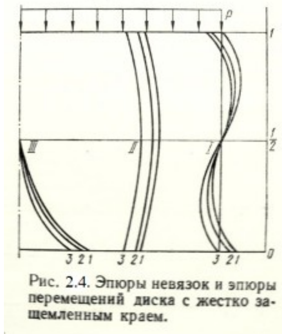
Рисунок 2.4. Эпюры невязок и эпюры перемещений именно существенно трёхмерного сплошного цилиндрического тела (элемента) с жёстко зашщёмлённым краем.
